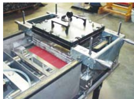
Test sullo Scivolamento Diretto dell' Enkagrid® PRO presso i laboratori tBU
